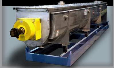
CONTINUOUS MIXER DIRECT GAS INJECTION FOR BOTANICAL CONDITIONING AND FREEZING
